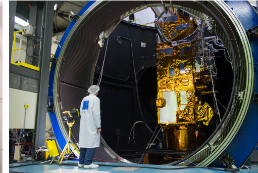
IASI FM3-R on Metop C PLM in ESA Thermal Chamber
