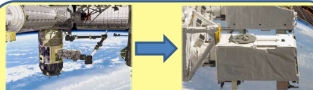
船外貨物として打上げ、そのまま船外ポートへ取り付けて利用 例:MAXI(X線観測): 寸法0.8m×1.0m×1.85m、重量約500kg
